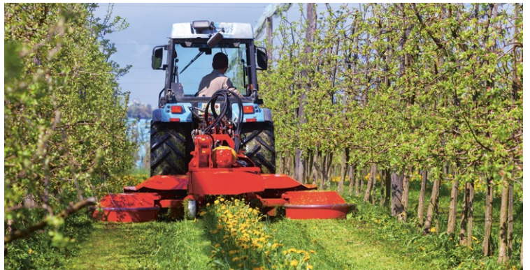
Dispositif de fauche (modèle «Humus OMB®»). Une bonne gestion de la couverture végétale (rang et inter-rang) et de la bande fleurie est cruciale et doit être réalisée en fonction des spécificités du site.
